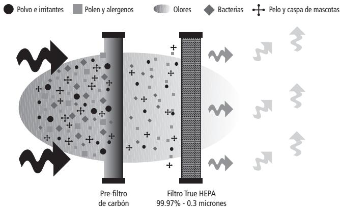
La ilustración de arriba indica la forma en que funciona el Purificador de aire True HEPA **QuietFlo®**. El polvo y otros irritantes son aspirados por el sistema de purificación de aire y limpiados a través del filtro HEPA. El aire limpio y purificado es liberado dentro de la habitación.
