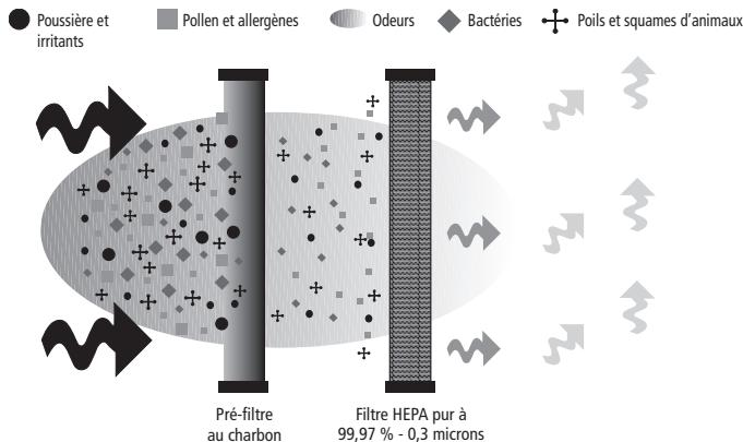
Ci-dessus se trouve une illustration du fonctionnement du purificateur d'air HEPA ***QuietFlo***®. La poussière et les autres irritants sont aspirés dans le système de purification d'air et nettoyés par le filtre HEPA. L'air propre et purifié est libéré dans la pièce.
